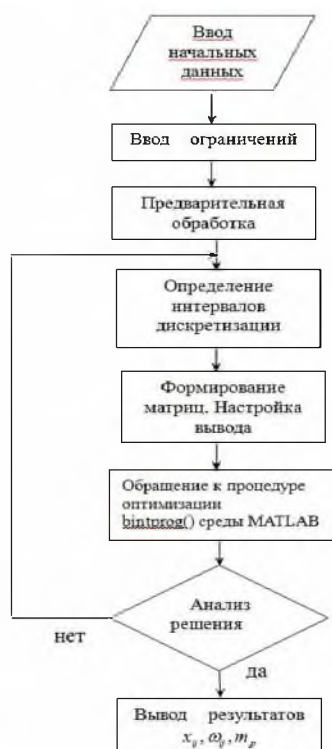
Блок-схема алгоритма расчета оптимального режима работы насосной станции
